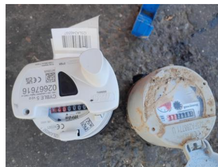
Mise en place d'une antenne émettrice sur un compteur d'eau
